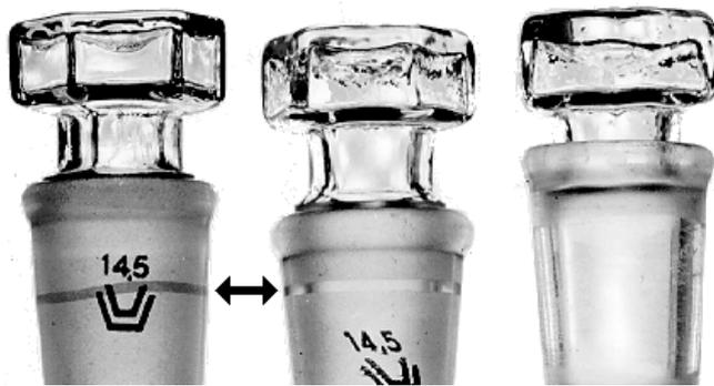
**Links:** Dichtring vor dem Anpressen der 2 Schliff-Teile
